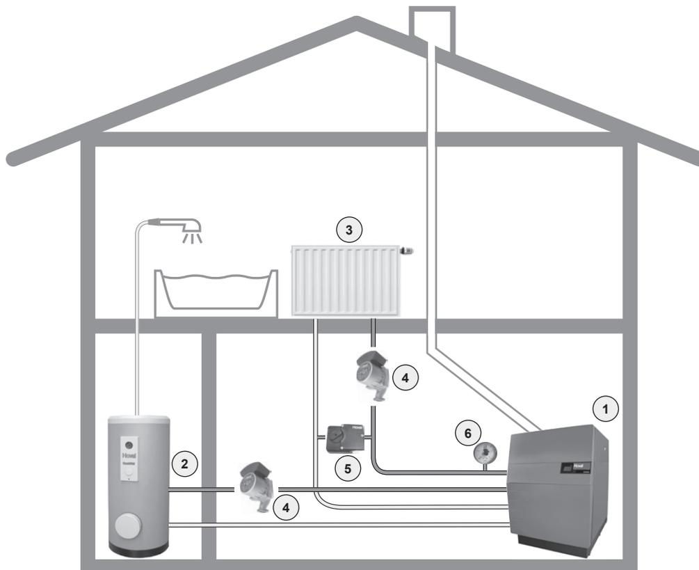
L'acqua di riscaldamento riscaldata dalla caldaia viene convogliata ai radiatori oppure viene utilizzata per il riscaldamento dell'acqua calda (bollitore).
